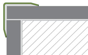
**PROTECT Profilo di protezione per spigoli, Profilo per staffe di ancoraggio**
