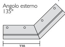
**PROCOFORM K Profilo per balconi, bordo rialzato con fessure di scarico fresate, base di supporto fustellata**
