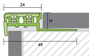
**PROBASIC Cappuccio terminale per profili per gradini con inserto in PVC**
