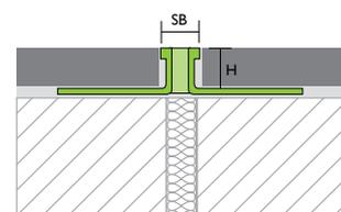
**PROCONNEXcurve - Profilo flessibile per letto sottile in metallo con inserti in silicone** W01
